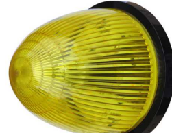
LEDマーカー SA-ML 部品コード：4HA179 灯体寸法 88φ×82.3mm 定格入力電圧 24V 定格消費電力 42mA(DC24.0V)
