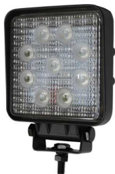
作業灯（LED）JG-W091 部品コード：4HA167 灯体寸法 (mm) 109(W)×109(H)×37.5(D) 定格入力電圧 DC9～32V 光束 2200lm 防水性能 IP67
