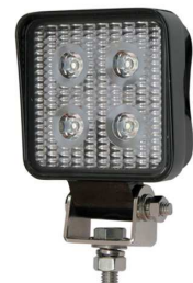
作業灯（LED）LSL-1011A 部品コード：4HA159 灯体寸法 (mm) 72(W)×72(H)×43(D) 定格入力電圧 DC12V、DC24V 定格消費電力 9W 光束 820lm 防水性能 IP67
