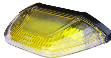
LEDマーカー&アンダーライト SMLUL-24Y 部品コード: 4HA208 灯体寸法(mm) 162.3(W)×47.3(H)×80(D) 定格入力電圧 24V 定格消費電力 2.4W
