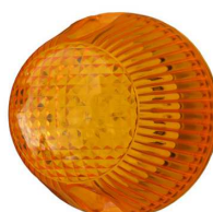
LEDマーカー 2560A（アーバン） 部品コード：4HA096 灯体寸法 80φ×55mm 定格入力電圧 24V 定格消費電力 0.7W
