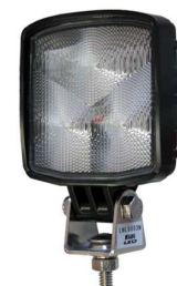
作業灯（LED）LWL-9003W 部品コード：4HA164 灯体寸法 (mm) 77(W)×75.5(H)×33(D) 定格入力電圧 DC12V、DC24V 定格消費電力 9W 中心光度 950cd 防水性能 IP67
