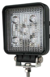
作業灯（LED）LSL-1002B 部品コード：4HA193 灯体寸法 (mm) 110(W)×110(H)×41(D) 定格入力電圧 DC12V、DC24V、DC48V 定格消費電力 15W 光束 1100lm 防水性能 IP67
