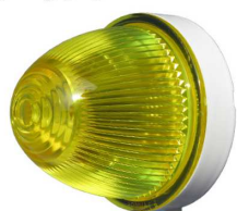
アクリルマーカーランプ（イエロー） 部品コード：4HA091 灯体寸法 83.5φ×76mm 電球 24V6W
