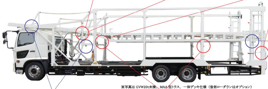
※写真は GVW20t未満、MAA 型トラス、一体デッキ仕様 (後部ローダウンはオプション)
