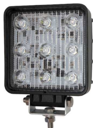
作業灯（LED）LSL-1007B 部品コード：4HA194 灯体寸法 (mm) 117(W)×117(H)×50(D) 定格入力電圧 DC12V、DC24V、DC48V 定格消費電力 27W 光束 1450lm 防水性能 IP67
