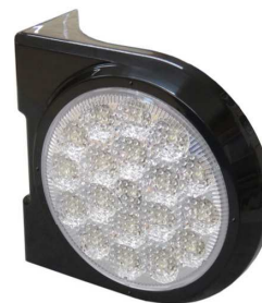
LED 後退灯 VS-L141VW+VS-L3D 部品コード：4HA029 定格入力電圧 DC12V、DC24V 定格消費電力 3.9W 防水性能 JIS D 0203 S2 灯体寸法 (mm) 128(W)×136(H)×28(D)
