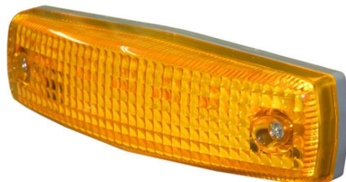
LED ランプ JB-406-AA 部品コード: 2YGHHE 灯体寸法 (mm) 124(W)×33.4(H)×22.5(D) 電圧範囲 DC20V ~ DC30V 定格消費電力 0.6W(DC24.0V)
