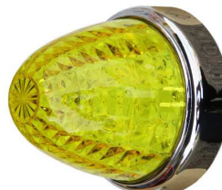
LEDクリスタルマーカーYY LSL-201Y 部品コード：4HA112 灯体寸法 90φ×85.4mm 定格入力電圧 12V、24V 定格消費電力 4W
