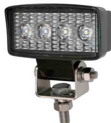
作業灯（LED）LSL-1010A 部品コード：4HA158 灯体寸法 (mm) 75(W)×40(H)×46(D) 定格入力電圧 DC12V、DC24V 定格消費電力 9W 光束 820lm 防水性能 IP67
