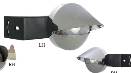
LED路肩灯 部品コード：4HA033 (LH) 部品コード：4HA034 (RH) 定格入力電圧 DC12V、DC24V 定格消費電力 3W 防水性能 IP65
