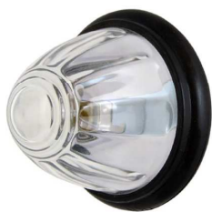
マーカーランプ (クリア) 部品コード: 4HA098 灯体寸法 88φ×74.5mm 電球 24V12W
