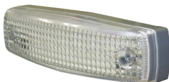
LED ランプ JB-506CC 部品コード: 2YGHHU 灯体寸法 (mm) 124(W)×33.4(H)×(D) 定格消費電力 24V 発光色 白
